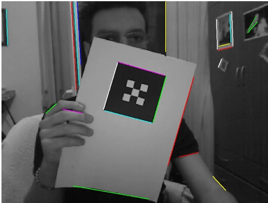
Εικόνα 85 - Οι edges του marker πριν την ανίχνευση του περιγράμματός του
