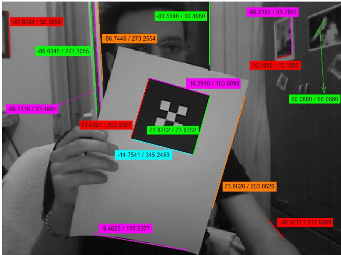
Εικόνα 82 - Οι διευθύνσεις και οι “κατευθύνσεις” όλων των edges σε ένα frame
