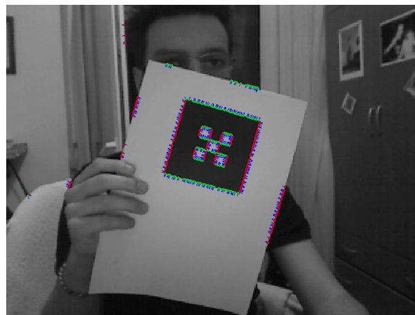
Εικόνα 69 - Επίδραση υψηλής τιμής κατωφλίου φωτεινότητας στην ανίχνευση των edgels
