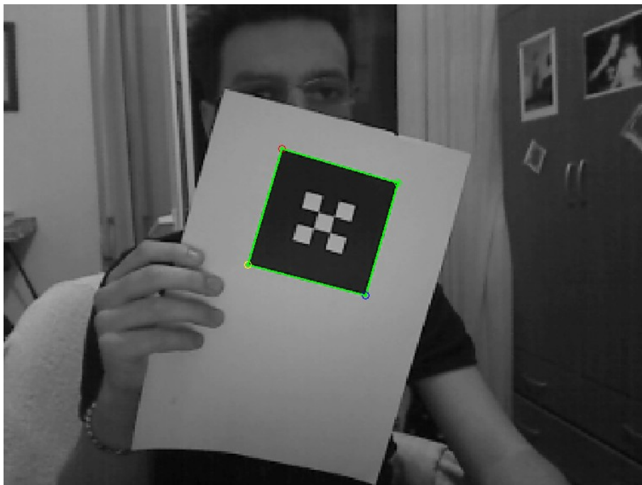
Εικόνα 86 - Ανίχνευση του περιγράμματος του marker
